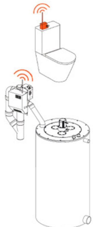
Funktaster, Abwasserweiche und Wärmetauscher
